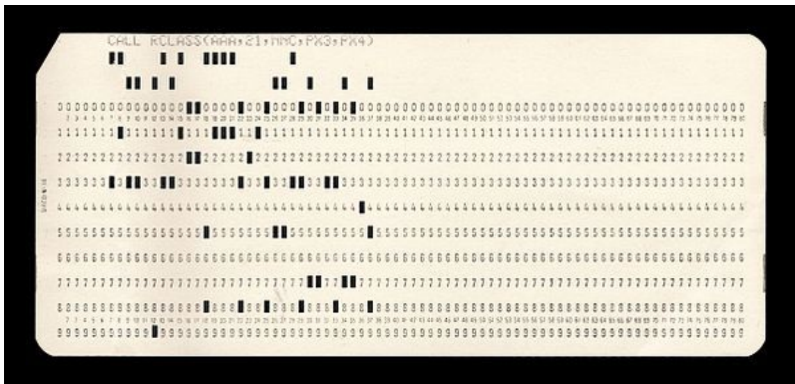
Carte perforée à 80 colonnes, sur laquelle est codée le texte de programmation « CALL RCLASS (AAA,21,NNC,PX3,PX4) »
